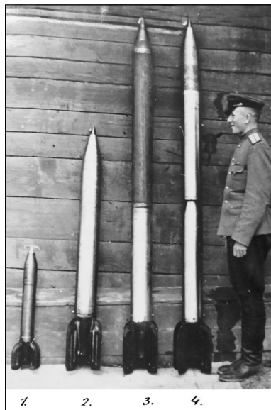
Рис. 10. Виды реактивных снарядов: 1 – 82-мм реактивный снаряд М-8; 2 – 132-мм реактивный снаряд М-13; 3 – 132-мм реактивный снаряд М-20; 4 – 132-мм реактивный снаряд М-13-ДД
