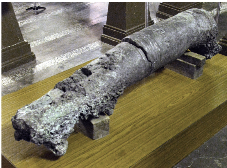
Ил. 1. Ствол 4-гривенковой (85 мм) пушки, отлитый из однородной бронзы мастером Московского пушечного двора Кашпиром Ганусовым в середине XVI в. Дульная и средняя части пушки сильно оплавилась от пожара Ил. 2. На казенной части надпись «Кашпир»
