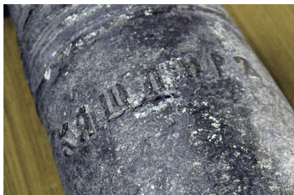
Ил. 1. Ствол 4-гривенковой (85 мм) пушки, отлитый из однородной бронзы мастером Московского пушечного двора Кашпиром Ганусовым в середине XVI в. Дульная и средняя части пушки сильно оплавилась от пожара Ил. 2. На казенной части надпись «Кашпир»
