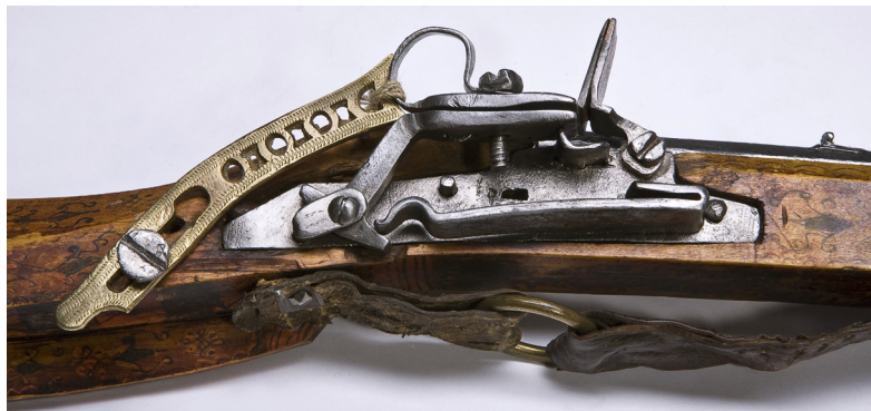
Ил. 9. Кремневый замок русского типа ружья № 1036-244 из собрания Кунсткамеры
