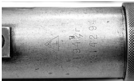
Рис. 4. Заводская надпись на пистолете-пулемете ППД-40, изготовленном на заводе № 209 (им. Кулакова) в 1942 г.
